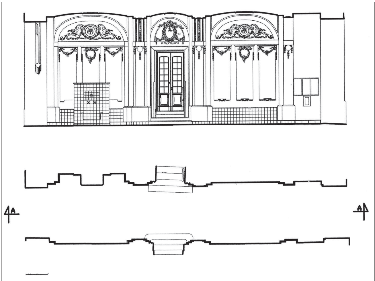
2. Warszawa, ul. Poznańska 38, kamienica (1911-1912), przejazd bramny, rzut dolny, przekrój podłużny. Pomiar ZHAP WAPW, 2011 2. Warsaw, 3 Poznańska St., tenement house (1911-1912), gate passage, lower plan, longitudinal section. Measurement ZHAP WAPW, 2011
