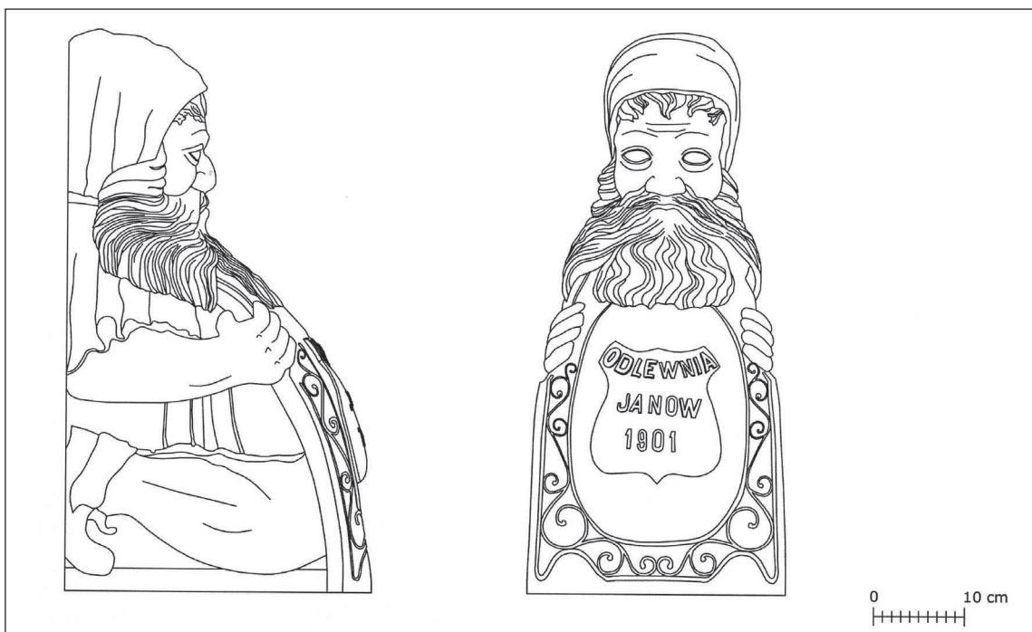
20. Warszawa, ul. Mokotowska 57, kamienica (1901), odboje żeliwne w formie krasniali przy narożach przejazdu bramnego. Pomiar ZHAP WAPW, 2007
