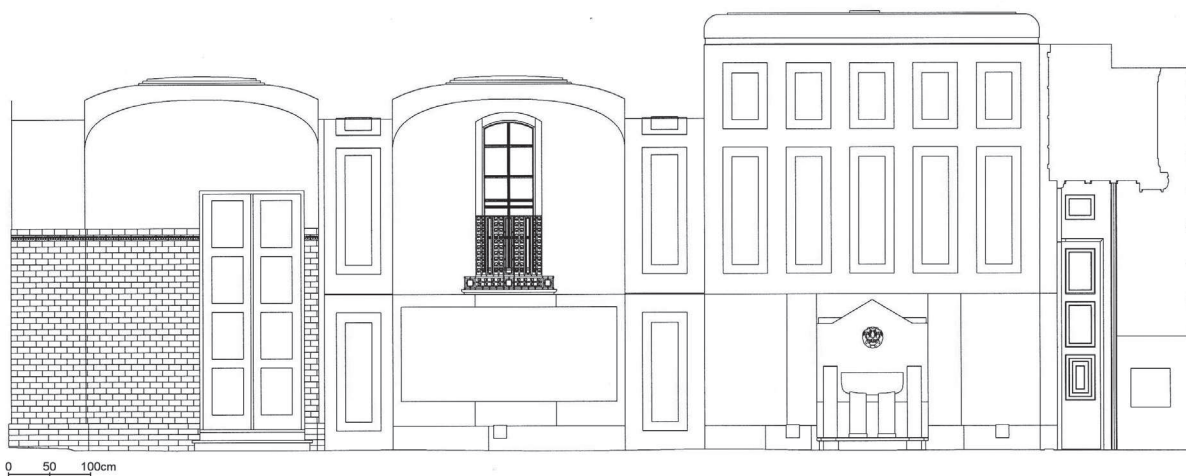
35c. Przejazd bramny kamienicy przy ul. Nowogrodzkiej 40. Przekrój podłużny. Pomiar ZHAP WAPW, 2009 35c. Gate passage of the tenement house at 40 Nowogrodzka. Longitudinal section. measurement: ZHAP WAPW, 2009
